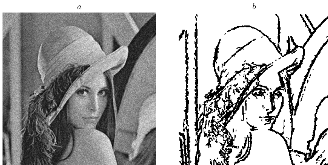
Рис. 6. Пример работы нейросетевого алгоритма при поиске перепадов яркости на реальном изображении: a — обрабатываемое зашумленное изображение, b — обнаруженные перепады яркости
