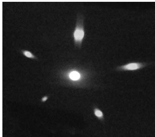
Рис. 13. Картина дифракции пучка белого света на образце квазикристалла
