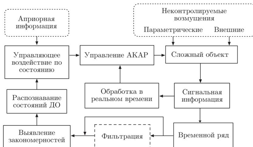
Рис. 1. Структурная схема совмещения традиционного управления по методу АКАР с адаптацией по состоянию для сложных ДО с неопределённостью (пунктирная линия означает необязательность операции для ДО, неопределённость в описании которых связана с нелинейным поведением его характеристик, а не аддитивными динамическими и/или измерительными помехами)
