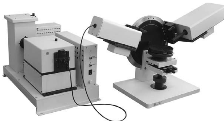
Рис. 3. Общий вид спектрального эллипсометра с блоком осветителя
