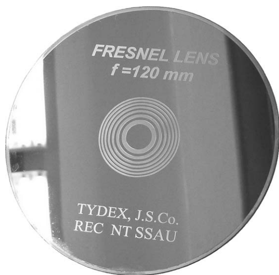
Рис. 3. Внешний вид изготовленной бинарной дифракционной линзы
