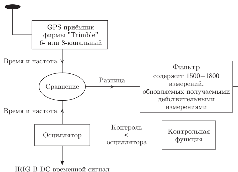
Рис. 3. Схема работы системы частотно-временной синхронизации XLi
