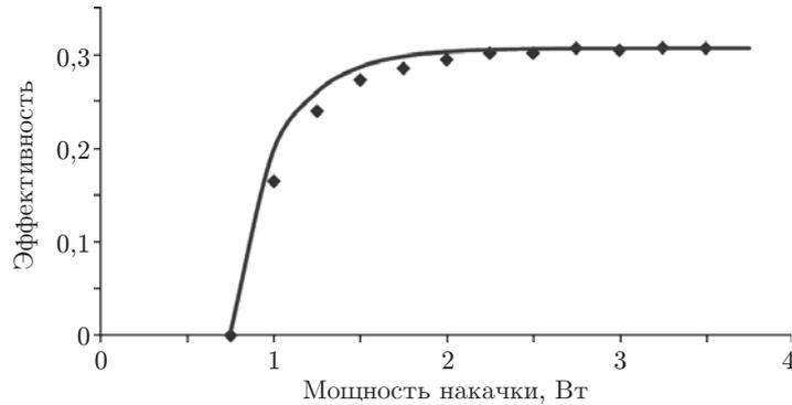
Рис. 9. Эффективность генерации  $\eta(P_{\text{in}})$  перестраиваемого СРОС-лазера при фиксированной длине волны акустооптического фильтра [25]
