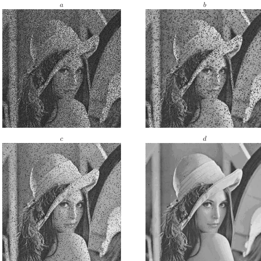
Рис. 3. Обработка цветного изображения при наличии ИП в каждом канале: a — искажённое ИП изображение; b — результат пространственно-избирательного медианного восстановления [8]; c — результат градиентной реконструкции; d — результат пространственно-избирательного медианного восстановления после градиентной реконструкции
