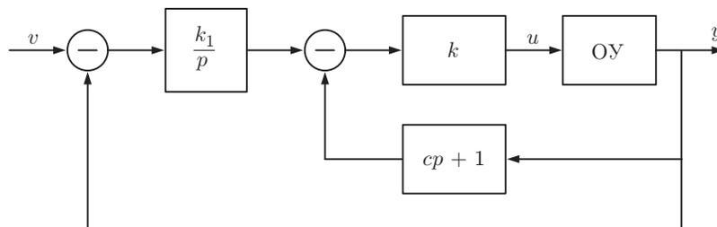
Рис. 1. Иллюстрация включения ПИД-регулятора (ОУ — объект управления)
