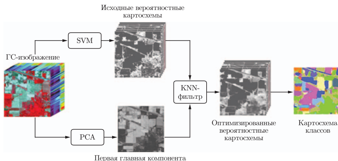
Рис. 8. Схема алгоритма классификации методом k ближайших соседей в сформированном пространстве признаков [65]
