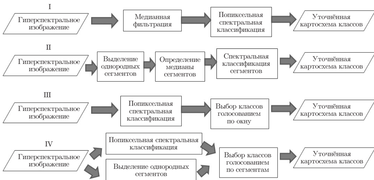
Рис. 12. Спектрально-пространственная классификация с включением в анализ информации о ближайшей окрестности на предварительном и заключительном этапах [88]
