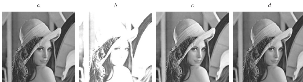
Рис. 3. Пример двухуровневого ДВП изображения «Лена» вейвлетом D4 : с использованием коэффициента в формате с плавающей точкой ( a ); предложенным методом при n = 3 , PSNR = 2,57 дБ ( b ), при n = 6 , PSNR = 23,60 дБ ( c ), при n = 9 , PSNR = 43,67 дБ ( d )
