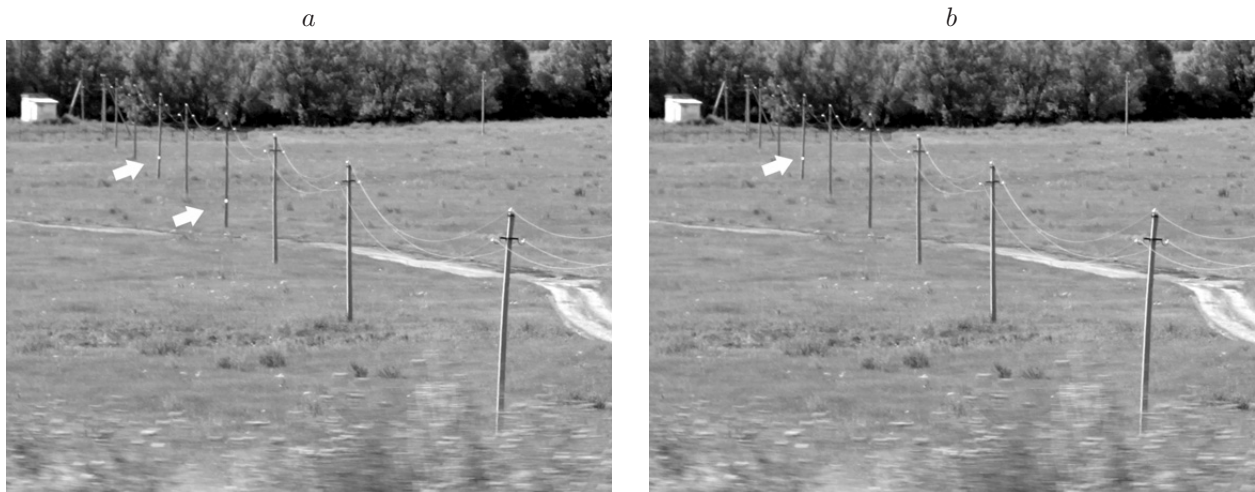
Рис. 2. Наблюдение отражённого света от катафотов, расположенных на расстоянии 150 и 200 метров: при установленной дальности 150 метров (а) и 170 метров (b)
