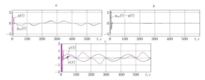
Результаты имитационного моделирования: a — выход объекта управления y(t) и выход эталонной модели  $y_m(t)$ ; b — сигнал ошибки  $y_m(t) - y(t)$ ; c — управляющий сигнал u(t) и внешнее возмущение  $\varphi(t)$
