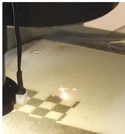
Рис. 3. Фотография процесса формирования слоя при нанесении покрытия на подложку
