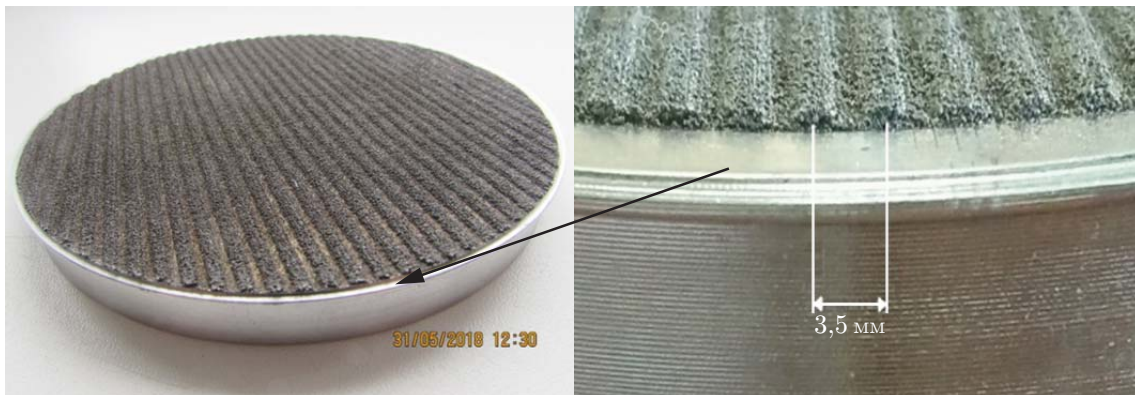
Рис. 5. Днище рабочей камеры экспериментальной установки: а — с нанесённым микроструктурированным капиллярно-пористым покрытием; б — увеличенный фрагмент поверхности микроструктурированного капиллярно-пористого покрытия с максимальной высотой 0,55 мм
