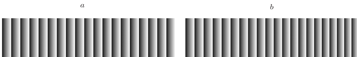
Рис. 3. Фазовые распределения изображений объекта при проекции на него 20 полос: до нагрузки (a) и после нагрузки (b)
