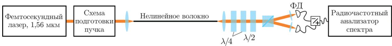
Рис. 2. Схема генерации поляризационно-сжатого света
