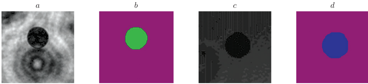
Рис. 2. Примеры сегментации: a — исходное изображение частицы размером 25 мкм, a — сегментированное изображение частицы размером 25 мкм, b — исходное изображение частицы размером 30 мкм, b — сегментированное изображение частицы размером 30 мкм
