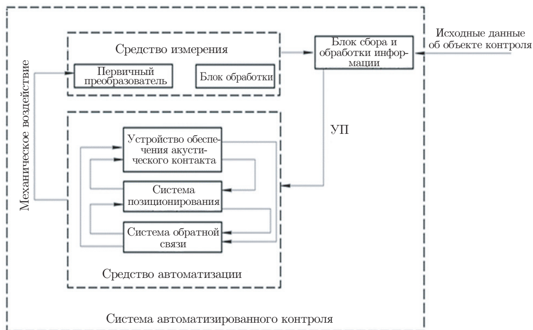
Рис. 7. Функциональная схема системы автоматизированного контроля
