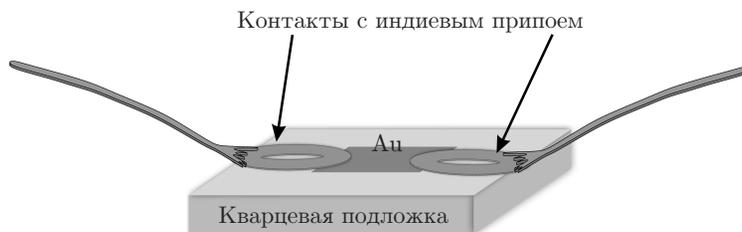
Рис. 1. Схематическое изображение макета ППН с припаянными контактами
