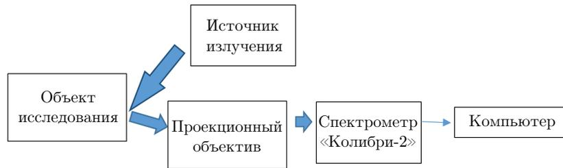
Рис. 1. Схема исследований спектральных характеристик фильтров
