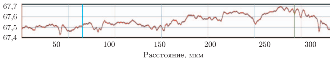
Рис. 4. Профилограмма поверхности образца из стали Р6М5 до обработки. Длина профиля 333 мкм, ширина 36,91 мкм, среднеквадратичное отклонение 0,052 мкм, разность глубин 0,123 мкм
