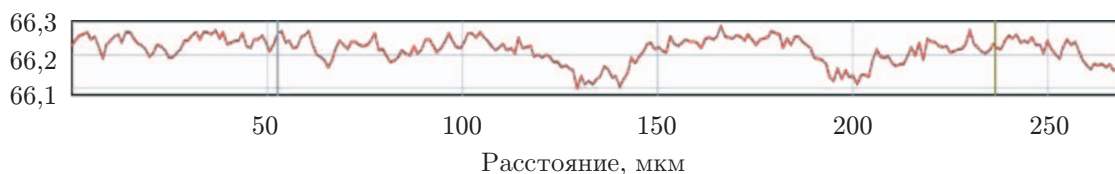
Рис. 5. Профилограмма поверхности образца из стали Р6М5 после обработки. Длина профиля 270 мкм, ширина 36,91 мкм, среднеквадратичное отклонение 0,031 мкм, разность глубин 0,032 мкм
