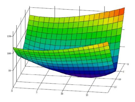
Рисунок 2. Распределение магнитного поля в магнитной ловушке QUIC. По вертикальной оси указан модуль магнитного поля в Гс, расстояния в горизонтальной плоскости указаны в миллиметрах.
