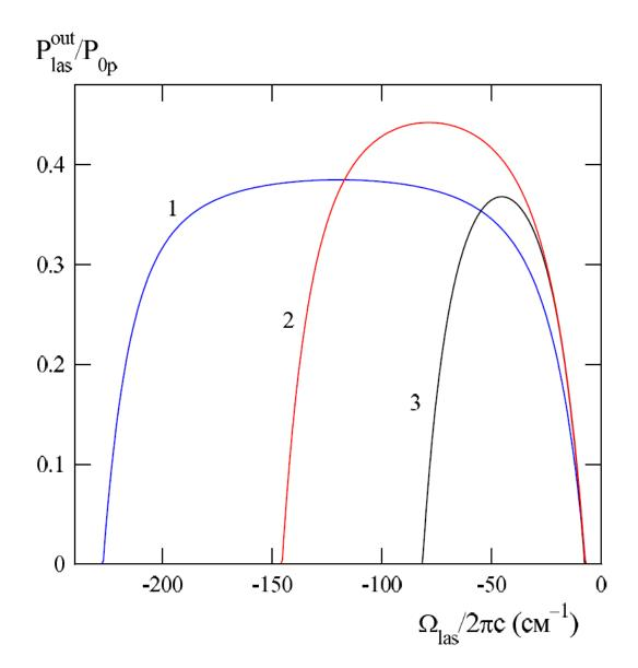
Рис. 9. Влияние коэффициента отражения выходного зеркала  $R_0$  на эффективность преобразования излучения накачки в лазерное излучение.
