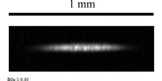
Рис. 3. Изображение облака холодных атомов рубидия в магнитной ловушке QUIC.
