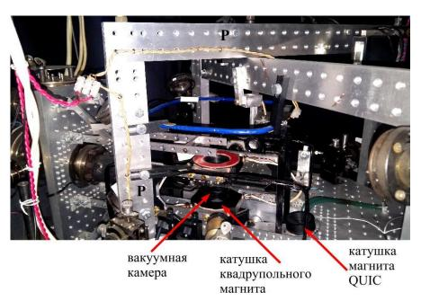
Рис. 1. Внешний вид установки для охлаждения атомов в магнитной ловушке OUIC.
