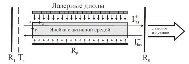
Рис. 8. Схема двухуровневого газового лазера с поперечной диодной накачкой.
