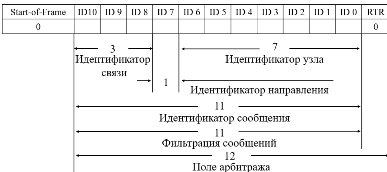
Рис.3. Значения бит поля арбитража в предлагаемом протоколе
