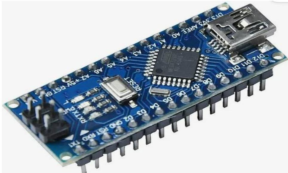
Рисунок 9. Микроконтроллер Arduino Nano-V3-ch340g
