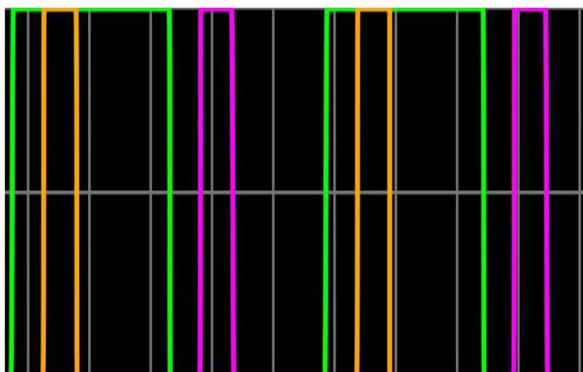
Рисунок 19 – Графики меандра, первого и второго тиристора с измененными временными характеристиками.
