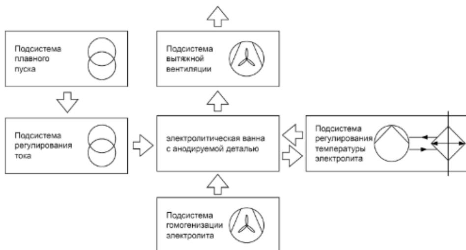
Рисунок 4. Базовая схема системы анодного оксидирования.
