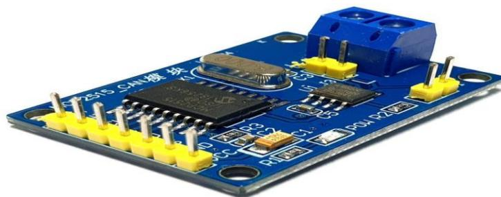
Рисунок 10. Контроллер MCP2515 шины CAN.
