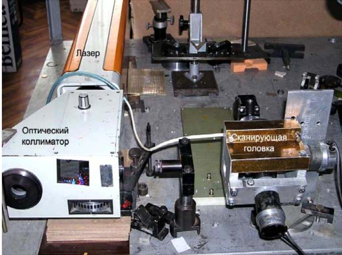
Разработанные в ИАиЭ СО РАН методы прецизионного многокоординатного сканирования лазерного луча позволяют изготавливать микроотверстия диаметром менее 50 мкм с нулевой или отрицательной конусностью в материалах толщиной 1–2 мм.
