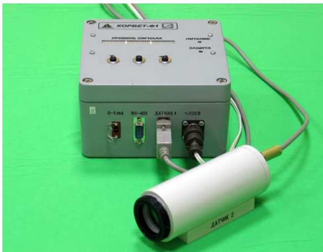
Внешний вид датчика и блока электроники устройства контроля факела фотоэлектронного «Корвет-Ф1»
